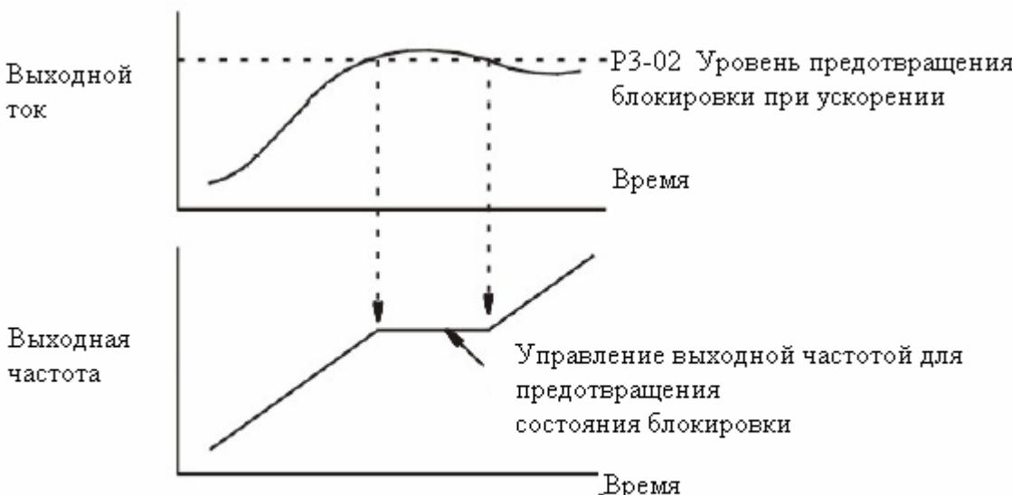
Функция предотвращения блокировки при ускорении (случай, когда
