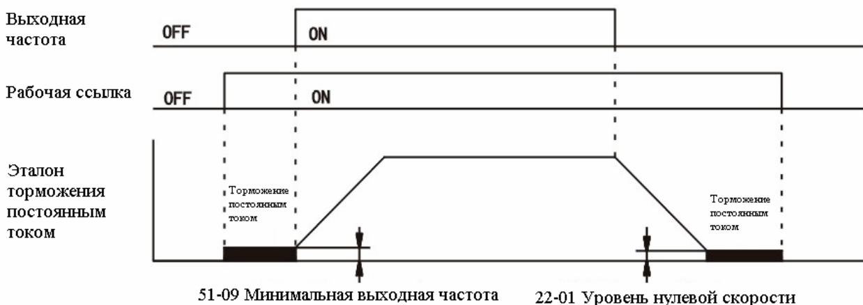
**Схема последовательности сигналов эталона торможения постоянным током.**
