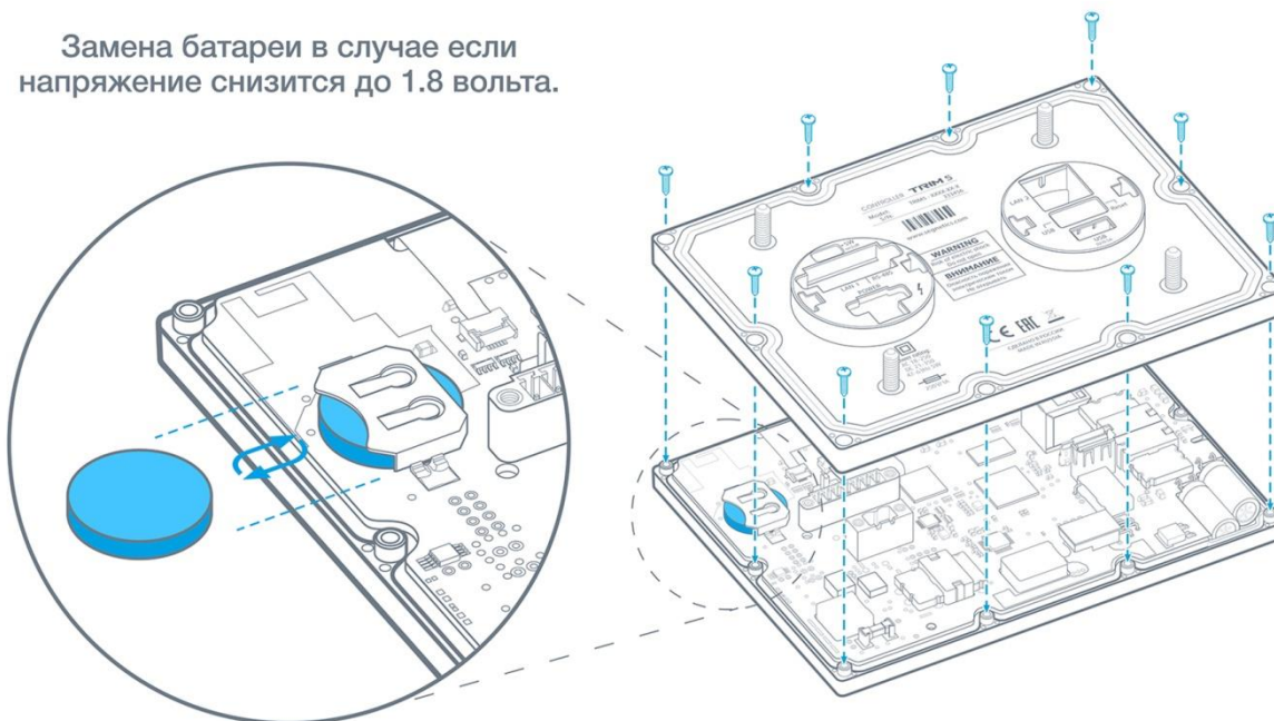
Рис. 14 - Порядок замены литиевой батареи
