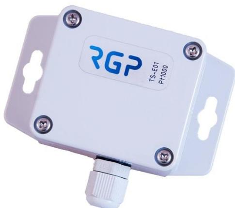
Датчики температуры наружного воздуха TS-E01 предназначены для измерения температуры пассивным чувствительным элементом, установленным внутри герметичного корпуса. Крепление корпуса осуществляется к наружной стене здания. Влияние температуры стены здания на показания датчика снижено за счет крепления измерительного элемента на боковой стенке корпуса.
