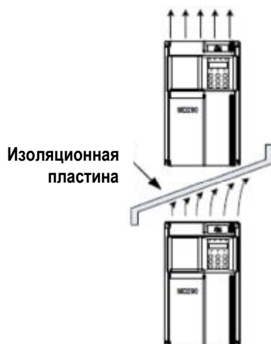
Рис. 3-2 Установка изоляционной пластины
