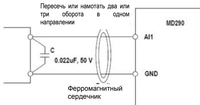
Рис. 4-6. Установить фильтрующий конденсатор или ферромагнитный сердечник
